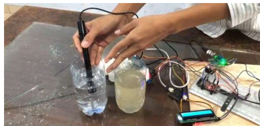
Gambar 5. sensor pH air pada air bersih
