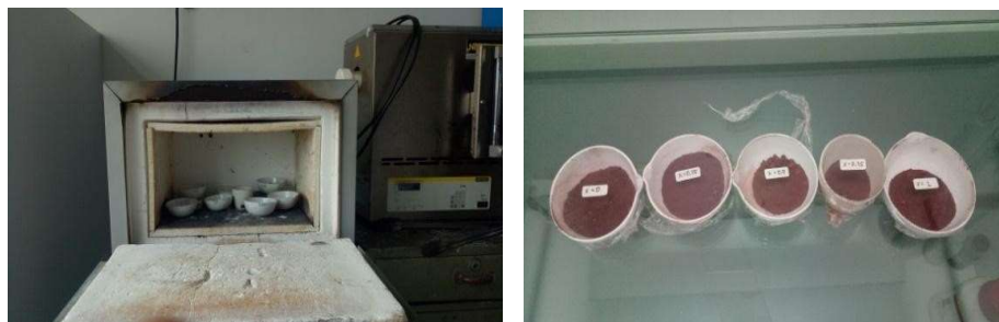
Gambar 4. Preparasi material BaFe_{12-2x}Co_xZn_xO_{19}
