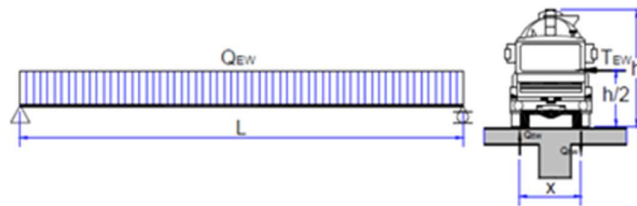
Gambar 7. Gaya angin tambahan horizontal di permukaan lantai jembatan. (Sumber: RSNI 02-2005)
